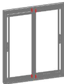
Imagen 12. Montaje de hojas centrales.
