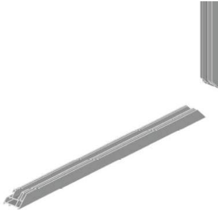
Imagen 1.1. Perfil marco perimetral con corte a 45°.
