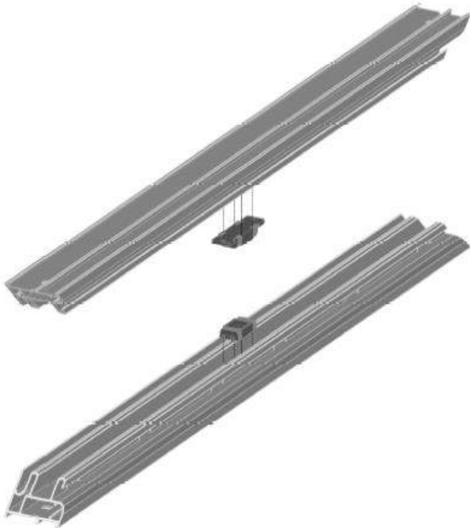
Imagen 7. Cortavientos en marco perimetral superior e inferior.
