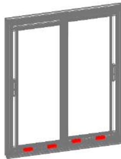
Imagen 8. Colocación de las ruedas en los perfiles horizontales inferiores.
